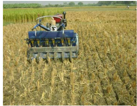
Fig.1. Strip till seed drill
