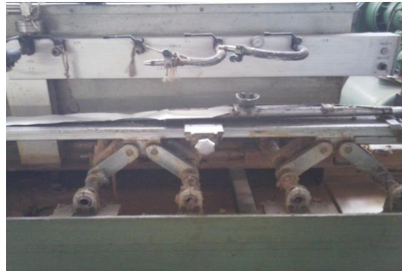
Coiling alu-tape using petrojelly
