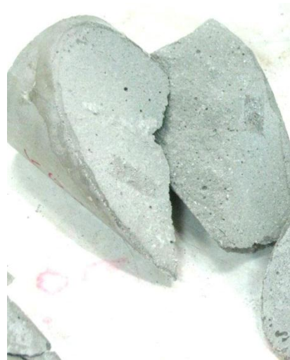
(d) Epoxy bond test sample after test.
