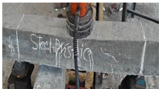
(d) Cracks in hybrid fiber beam
